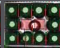
Incorrecto: faltan botellas
